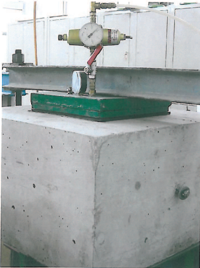
Bild 5: Prüfkörper während der Dichtigkeitsprüfung
