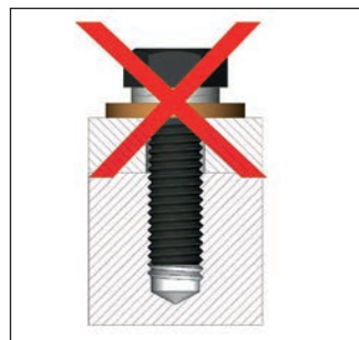
Keine Sicherungsfunktion in Kombination mit Unterlegscheiben
