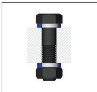
Sechskantschraube im Durchgangsloch beidseitig gesichert
