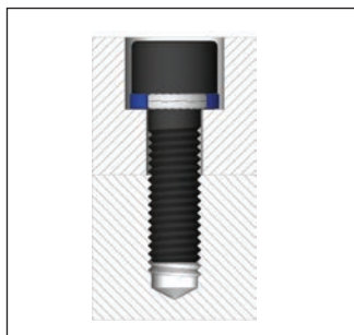
Zylinderschraube in Senkung gesichert
