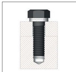
Sechskantschraube im Sackloch gesichert
