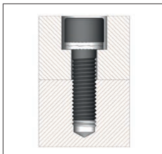
Zylinderschraube in Senkung gesichert
