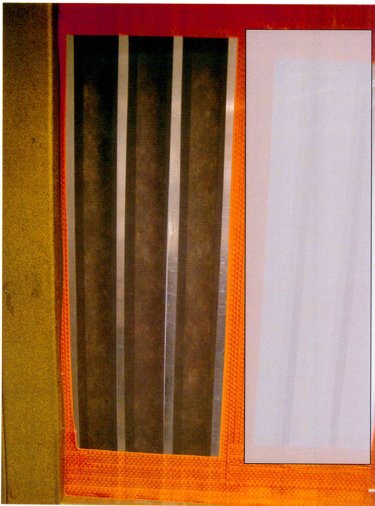
Bild 4: Versuchskörper, bestehend aus Hohlkammerprofilen (Querschnitt 60 mm x 100 mm) mit dazwischen befindlichen Fugen, über die die zu prüfenden Dichtungsfolien angebracht wurden (Fugenbreite 60 mm).
