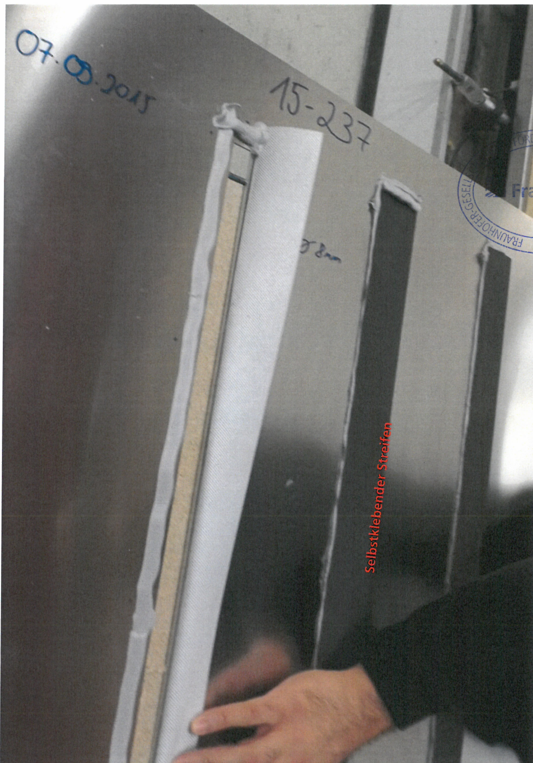
Bild 5: Montage des Dichtbandes »Würth DICHTBAND AUSSEN UV 12« und Verklebung mit dem Dichtbandkleber »Würth NAHTPASTE ÖKO« in Anlehnung an DIN 18542. Abweichend von der DIN 18542 überdeckt das Dichtband die drei Fugen (21 mm x 1000 mm).
