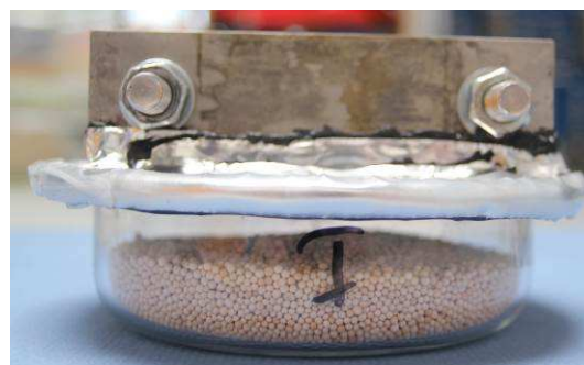
Bild 1 und Bild 2 Prüfaufbau von oben und seitlich nach Satz A mit eingebautem, komprimiertem Dichtband, Lagerung erfolgt bei den Umgebungsbedingungen 23 °C und 50 % r.h.
