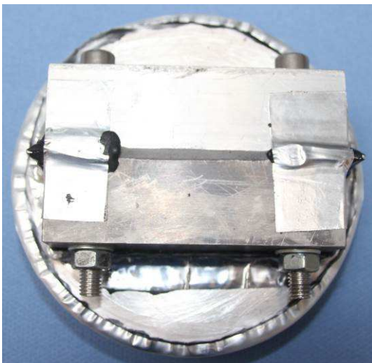
Bild 1 und Bild 2 Prüfaufbau von oben und seitlich nach Satz A mit eingebautem, komprimiertem Dichtband, Lagerung erfolgt bei den Umgebungsbedingungen 23 °C und 50 % r.h.
