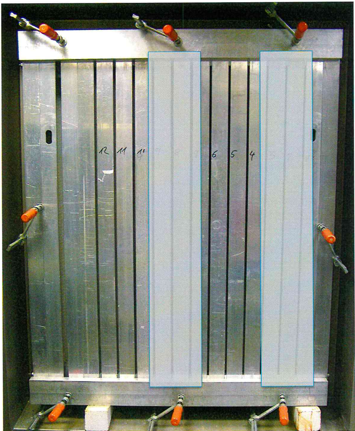
Bild 5: Versuchskörper eingebaut im Prüfstand
