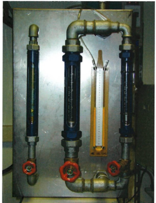
Bild 3b: Prüfstand-Steuerung (Wasser- u. Luftmenge)
