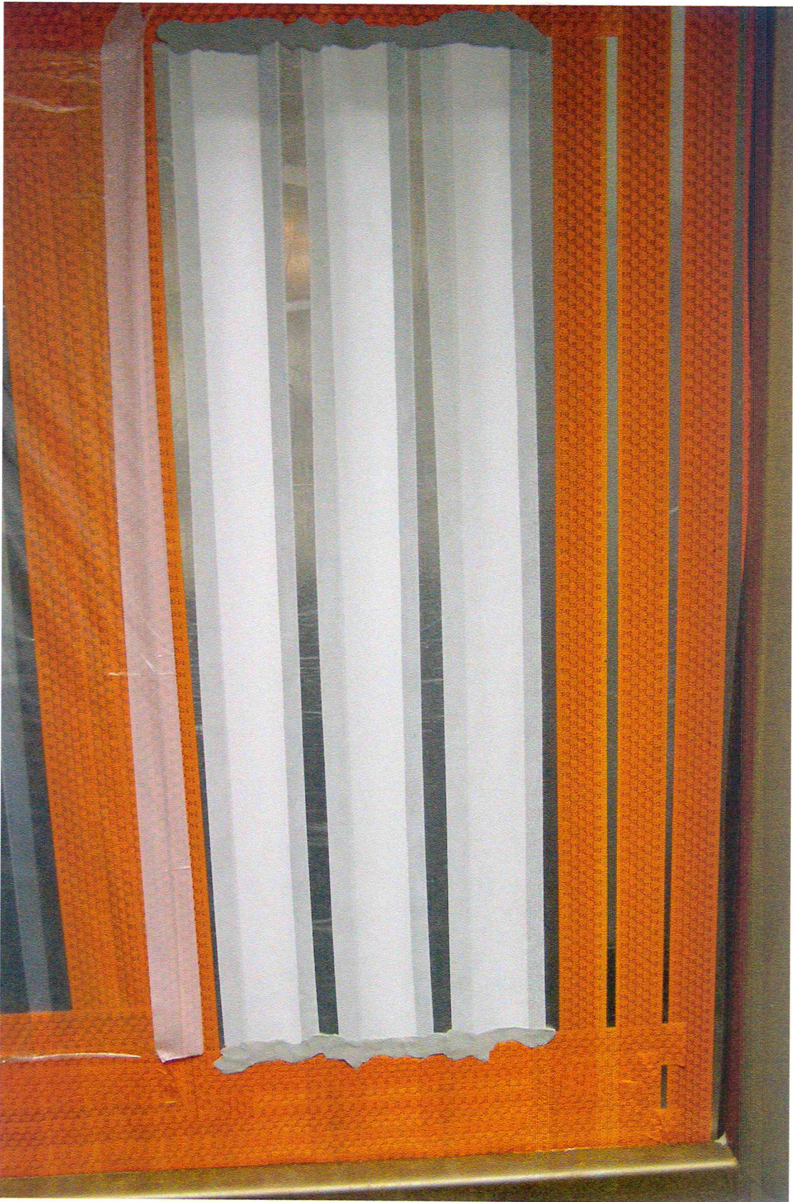
Bild 4: Versuchskörper, bestehend aus Hohlkammerprofilen (Querschnitt 60 mm x 100 mm) mit dazwischen befindlichen Fugen, über die die zu prüfenden Dichtungsfolien angebracht wurden (Fugenbreite 60 mm).
