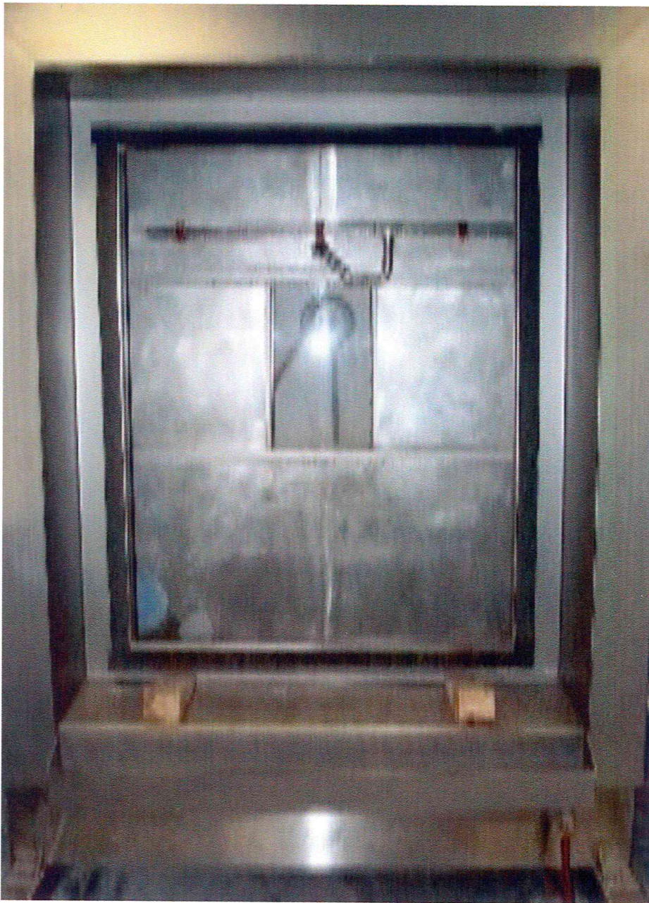
Bild 1: Offener Prüfstand ohne den eingesetzten Versuchskörper
