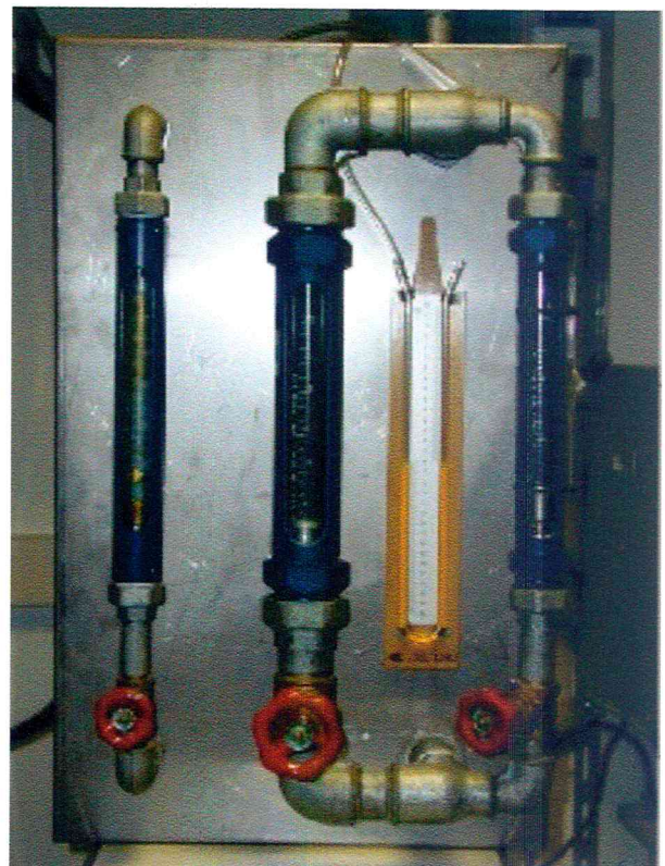
Bild 3b: Prüfstand-Steuerung (Wasser- u. Luftmenge)
