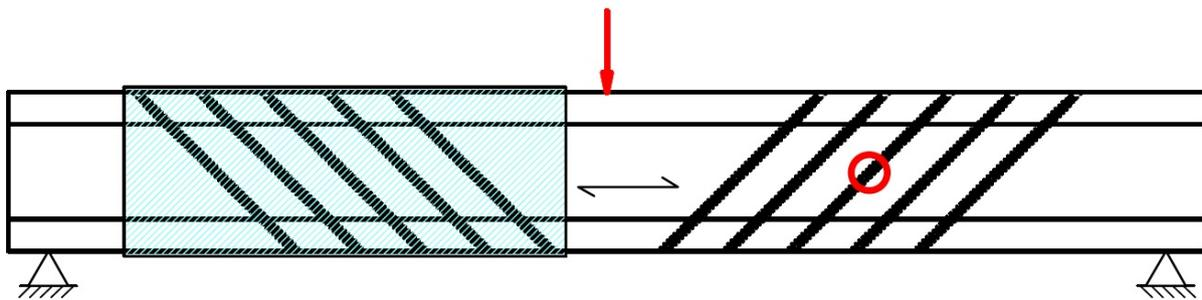
Abbildung A8.7: Schubverstärkung mit Schmid Schrauben
