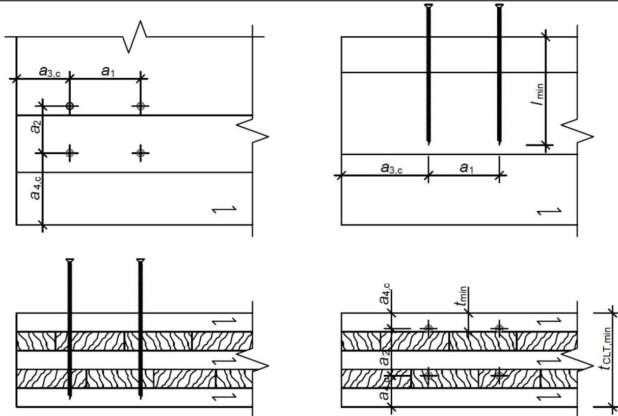
**Abbildung A6.1: Definition der Mindestabstände, End- und Randabstände in der Seitenfläche (links) und Schmalfläche (rechts) von Brettsperrholz**
