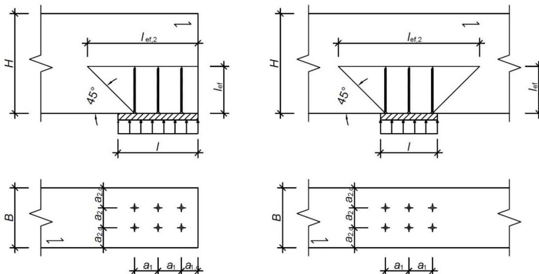
**Abbildung A8.1: Querdrukverstärkung von Holzbauteilen: Endauflager (links)
