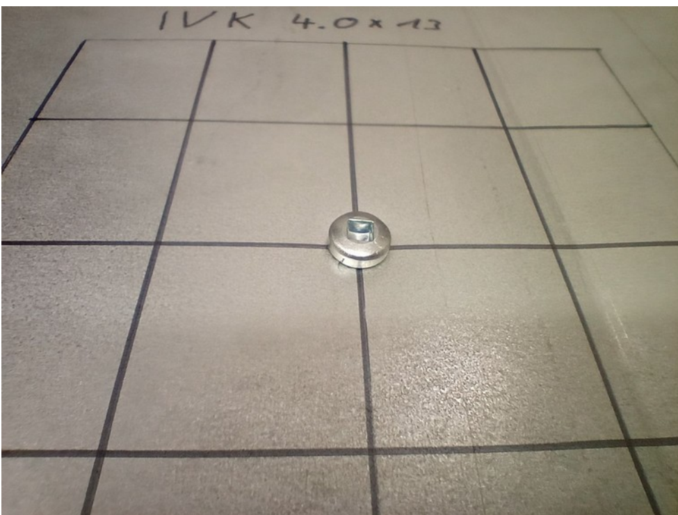
Abbildung 4.2: Luftkanal mit einer Dünnschraube des Typs 4KT-GR2-4,0X13
