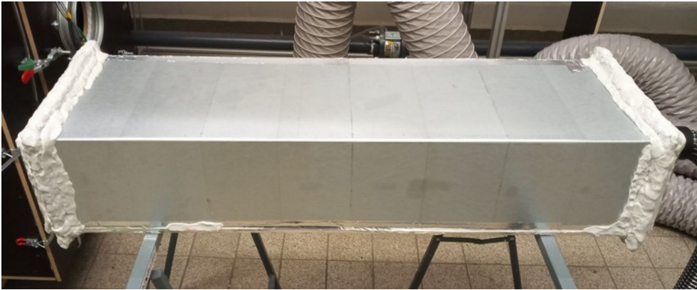
Abbildung 4.1: Luftkanal ohne Dünnschrauben
