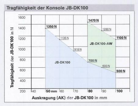
Bei grossen Fensterelementen oder sehr hohen Vertikallasten können die Montagekonsolen **JB-DK** ab einer Auskragung von 80 mm zusätzlich durch Abstützwinkel **AW75** verstärkt werden. Bei den ermittelten Werten handelt es sich um Laborwerte. Abweichungen in der Praxis sind nicht auszuschliessen. Befestigung im Wandbaustoff siehe gesondertes Datenblatt.
