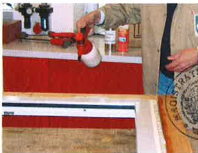
Würth Flex-Schaum Art.Nr. 0892 142 9 (siehe Beilage 1) Schaumdicke ca.43mm ungeschnitten
