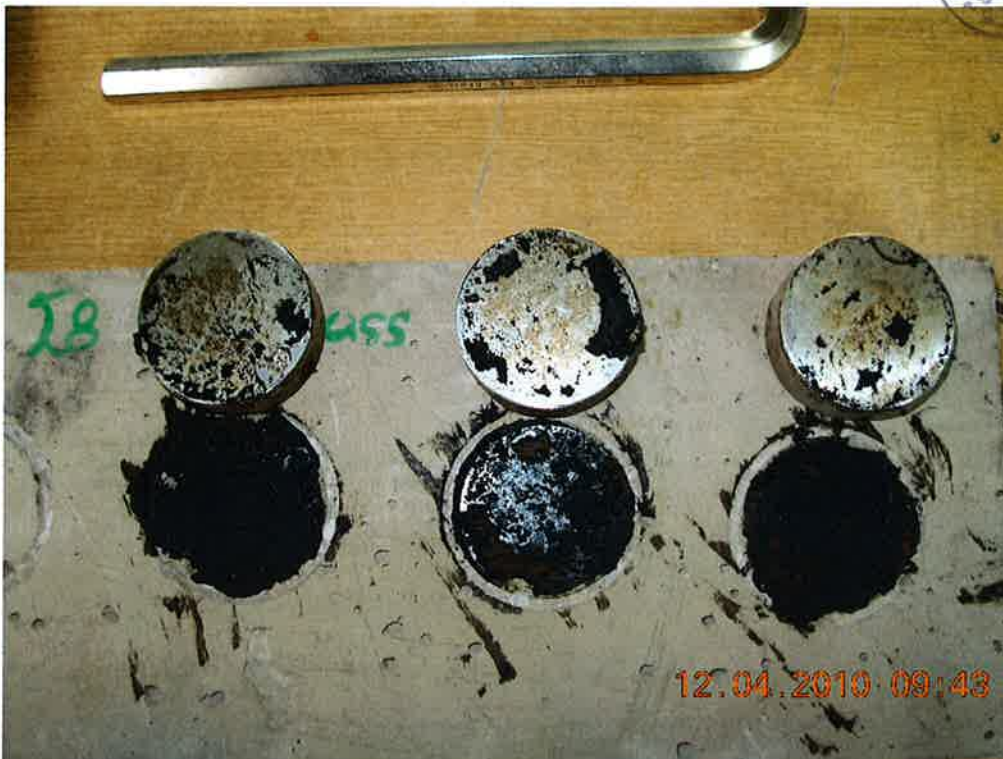
Abb.4 Prüfung Haftfestigkeit Proben nach Versuch
