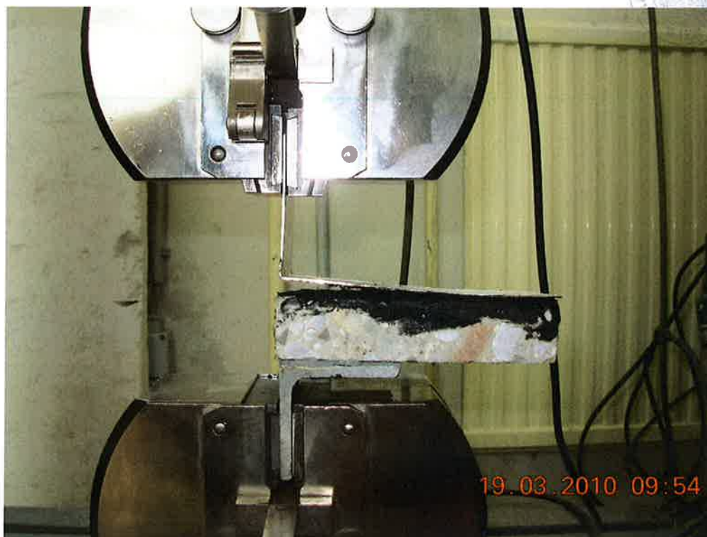
Abb.8 Prüfung Schälfestigkeit, während des Versuches
