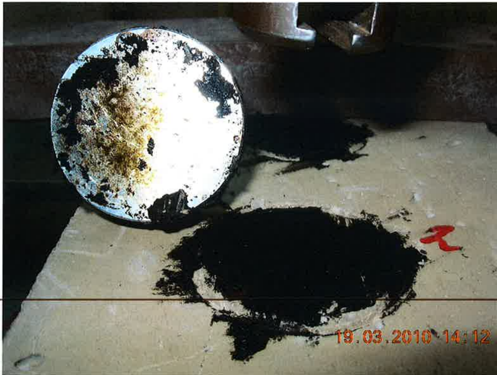
Abb.3 Prüfung Haftfestigkeit Probe nach Versuch
