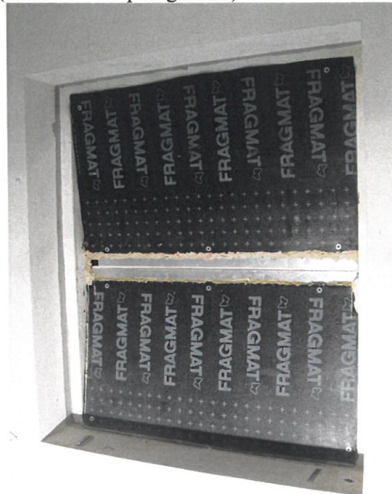
Testöffnung während der Messung (Labor 2 – Empfangsraum)
