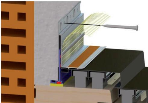
Wir empfehlen das Profil mit Hilfe der im Karton beigelegten Befestigungsnägel zu fixieren.
