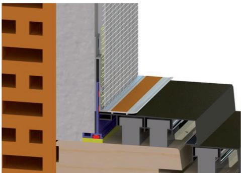
Die Flächenarmierung mit VWS-Gewebe wird nachfolgend bis zur Putzkante hingeführt und eingebettet.
