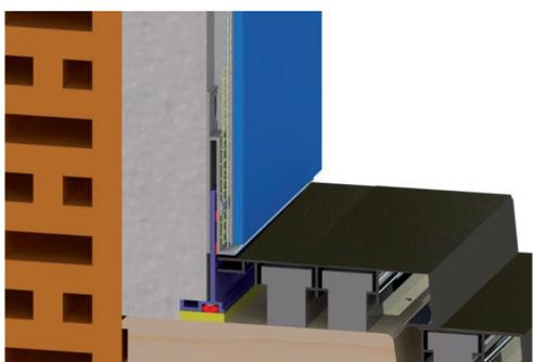
Abschließend die Abrisslasche knicken und abziehen. Die dauerhafte Umlüftung und Entwässerung hinter der Aluvorsatzschale bleibt bestehen.
