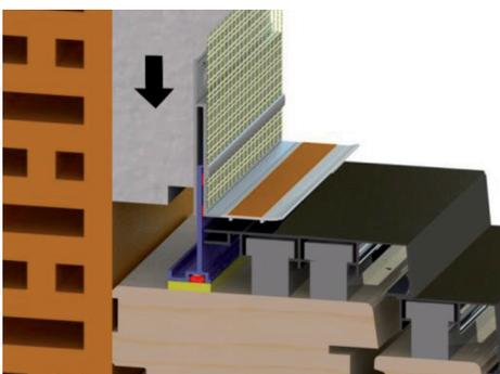
Anschließend den ausgeklinkten Dämmstoff, wie im Bild ersichtlich, anbringen.
