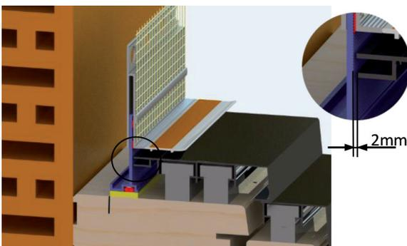
Das Aufnahmeprofil mit PE-Dichtband an der Markierung bündig ankleben.
