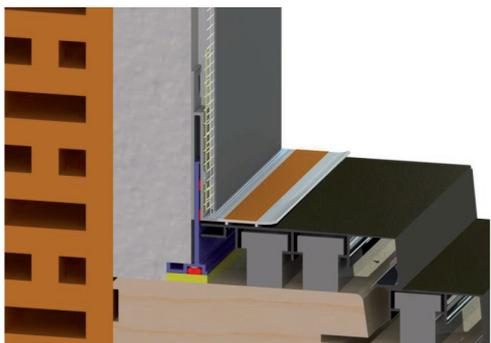
Die Armierung bzw. Endbeschichtung darf die Sollbruchstelle des Abknicksteges nicht überragen, da sonst der Abknicksteg nicht abgetrennt werden kann.
