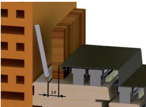
Die Fluchtlinie der vorgesetzten Aluschale, unter Berücksichtigung der Profil-Geometriebreite, mit Hilfe eines 14 mm breiten Passstücks (vorzugsweise Holz) am Holzrahmen markieren.
