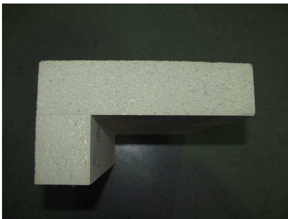
Bild 3 Querschnitt der zu prüfenden Montagezarge
