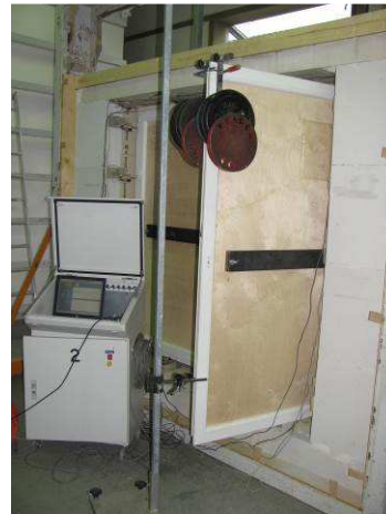
Bild 2 Probekörperansicht mit maximaler Auflastung während der Prüfung „Belastung mit Zusatzgewicht“
