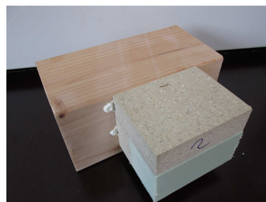
Bilder 3 bis 7 Probekörper Tragfähigkeit Klebung Zarge – Mauerwerk
