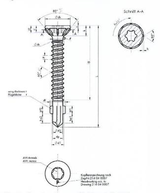
Flügelbohrschraube aus Kohlenstoffstahl
